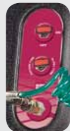
Valvola selezione funzione svuotamento/riempimento Vacuum/filling function selection valve Valve sélection des fonctions vidange/remplissage Auswahlventil Entleer-/Befüllfunktion
